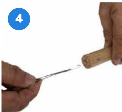
Utilizando un **taladro o punzón** realizar un orificio en el palo de escoba en uno de los extremos, e insertar el alambre previamente doblado.
