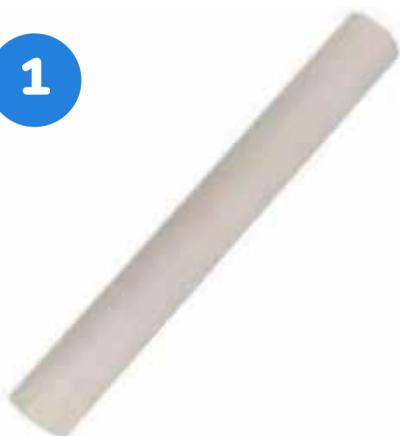
Se corta un pedazo de 50 cm de largo de un tubo de pvc de 50 mm de diámetro. Se utiliza una **sierra** de calar manual u otro tipo de sierra.
