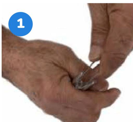
Cortar un pedazo de alambre de unos 30 cm utilizando **una pinza, alicates o cualquier otro elemento cortante**.
